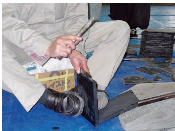
06 加工・小さく割った石に打撃を加えて割って薄く加工する
