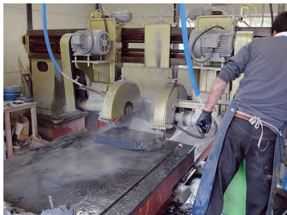
04 加工・石を素材に合わせて石を切っていく
