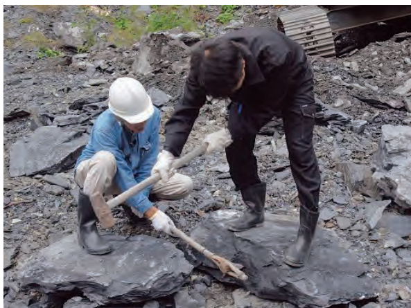
03 採石・掘り出した石を石槌と楔、矢などを使って板状に割る
